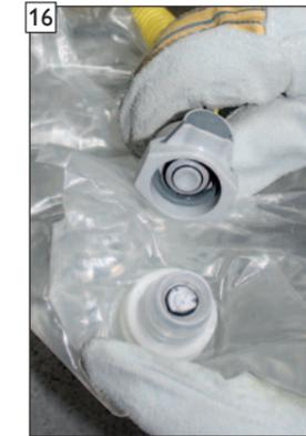
Durch Druck auf den Knopf der Kupplung kann der Kondensatauffangbeutel tropfsicher entkoppelt werden.
